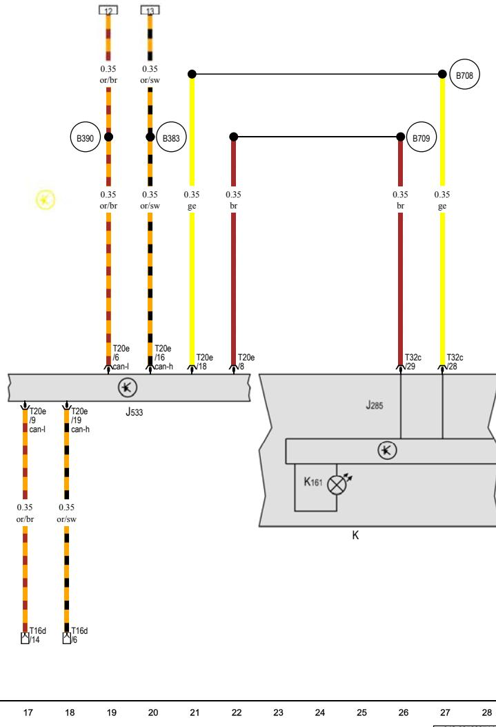
仪表板中的控制单元, 数据总线诊断接口, 电控机械式转向助力器指示灯
