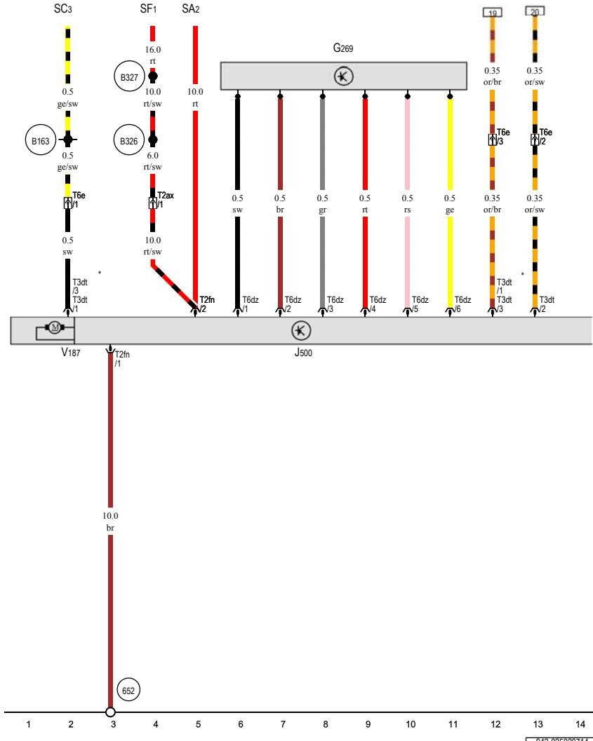
转向扭矩传感器, 转向辅助控制单元, 保险丝架 F 上的保险丝 1, 保险丝架 A 上的保险丝 2, 保险丝架 C 上的保险丝 3, 电控机械式伺服转向马达
